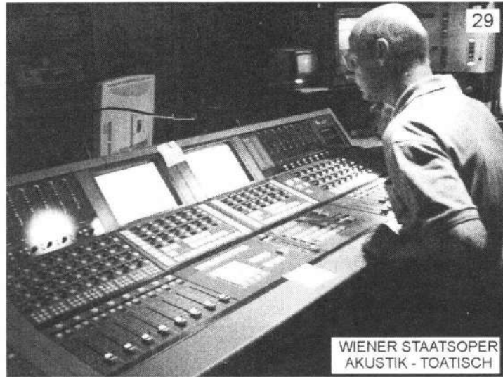
写真29 ウィーン国立歌劇場 音響室 東亜のミキシング卓
